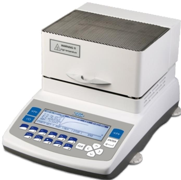
Termobilancia elettronica, misuratore di umidità, ad altissima risoluzione. DIVISIONE (g): 0,001. PORTATA (g): 210.
