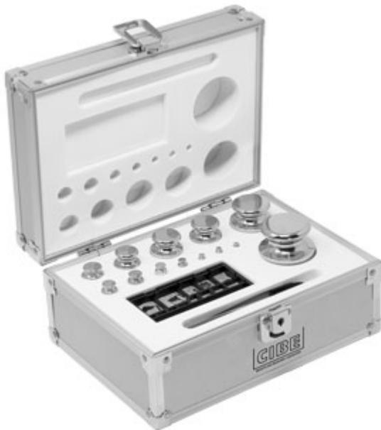
Pesiera con custodia in alluminio, completa di pesi in acciaio INOX in classe E2 secondo la raccomandazione OIML R111 e adatti per applicazioni di metrologia legale e nel settore industriale. La classe di precisione E2 consente l'utilizzo di questi pesi per il controllo la taratura di bilance e strumenti in classe I fino a 500.000e.
